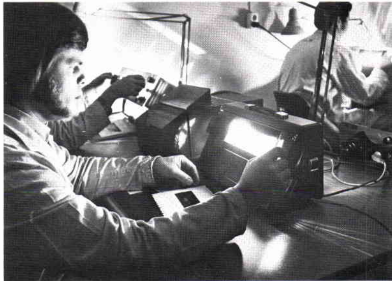
Gunder Persson FFV-U/CVÖ granskar vad radiogrammet (= "röntgenplåten") avslöjar om svetsens kvalitet.
