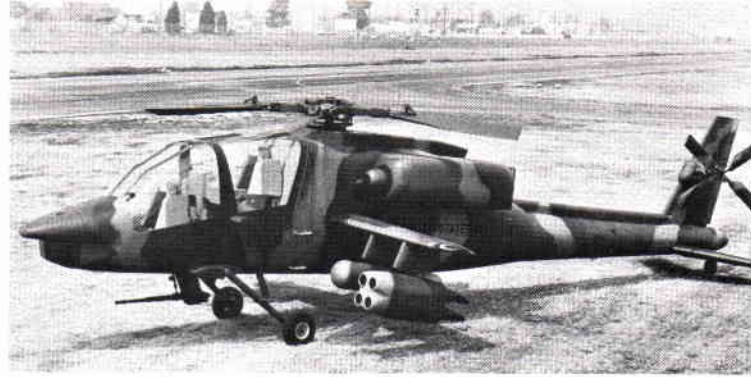
Väladdad Hughes YAH-64A, projekterad för T700-motorer.
